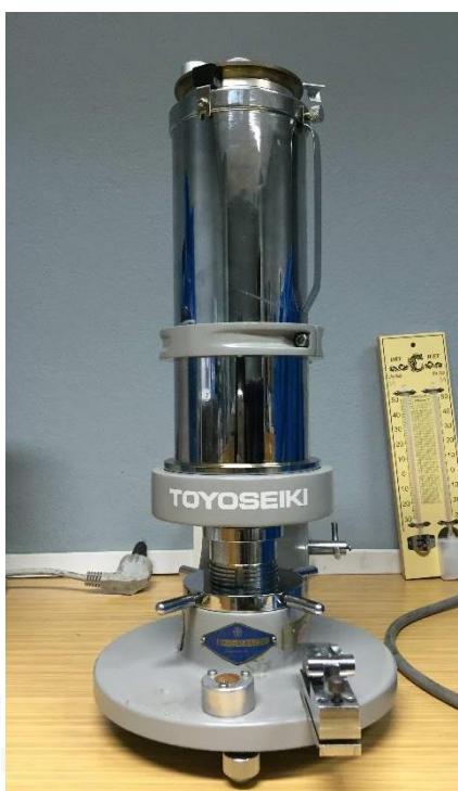
ภาพที่ 3-6 เครื่องทดสอบการซึมผ่านลมของกระดาษ
