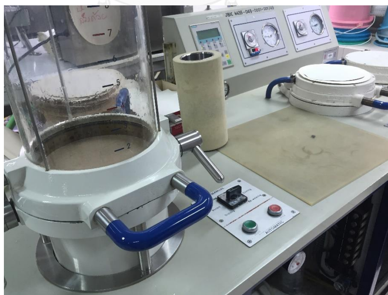
ภาพที่ 3-1 เครื่องขึ้นแผ่นกระดาษแบบรวดเร็วโดยวิธี Rapid Köthen
