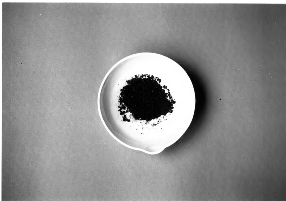
รูปที่ 4.14 ตะกอนผลึก Ag_2S ที่ได้จากการสร้างตะกอนผลึกด้วยสารละลายโซเดียมซัลไฟด์
