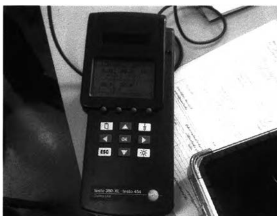
ภาพที่ 3.9 Data Logger เครื่องวัดค่าอุณหภูมิอากาศ (Ta) ความชื้นสัมพัทธ์ (RH)
