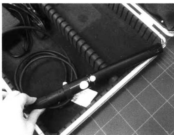
ภาพที่ 3.8 Testo 454 เครื่องวัดความเร็วลม
