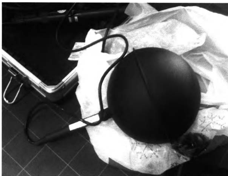
ภาพที่ 3.10 Globe เครื่องวัดอุณหภูมิการแผ่รังสีความร้อนเฉลี่ย (MRT)
