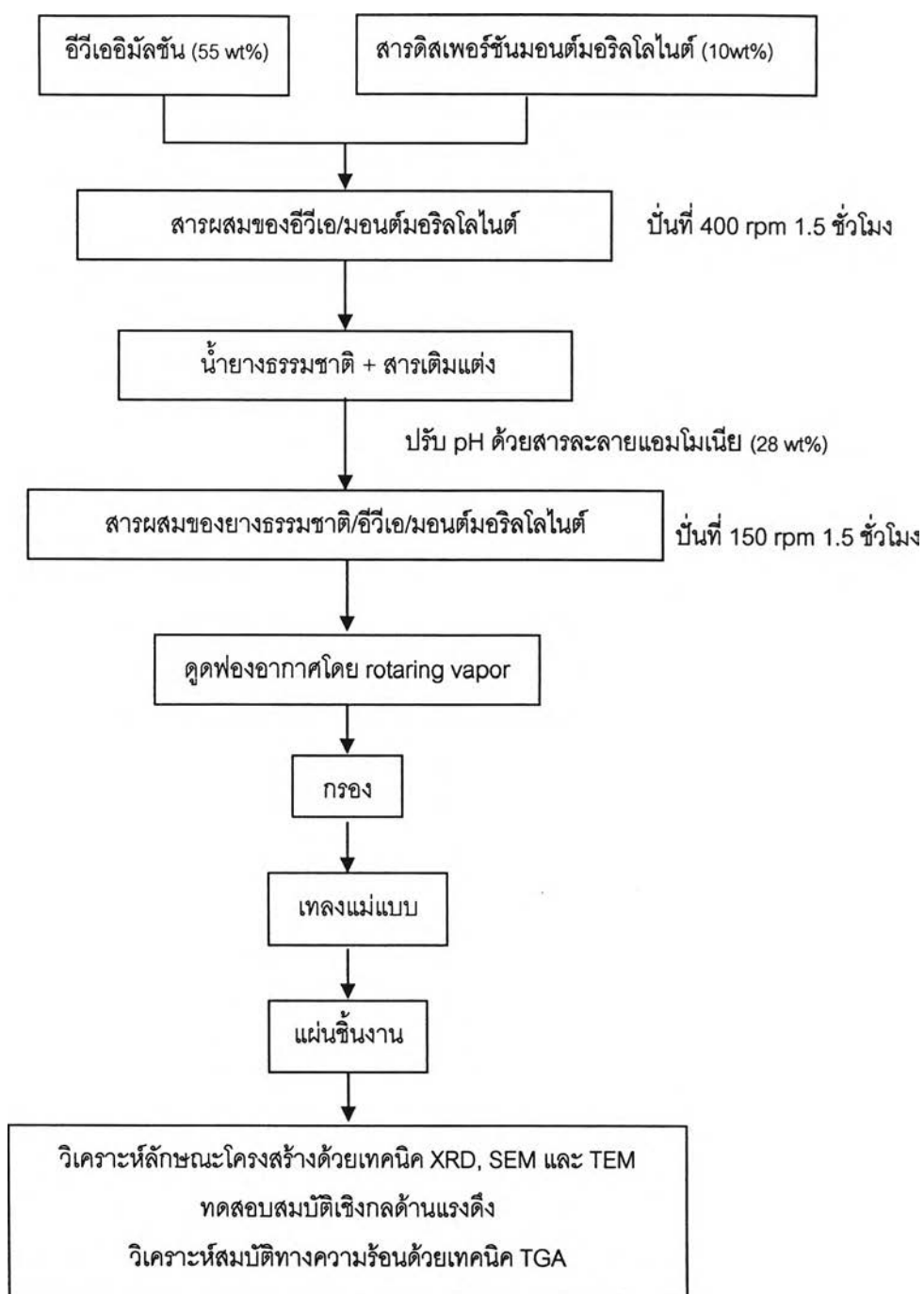
รูปที่ 3.6 ขั้นตอนการเตรียมยางธรรมชาติ/อิวีเอ/มอนต์มอริลโลไนต์นาโนคอมพอสิต
