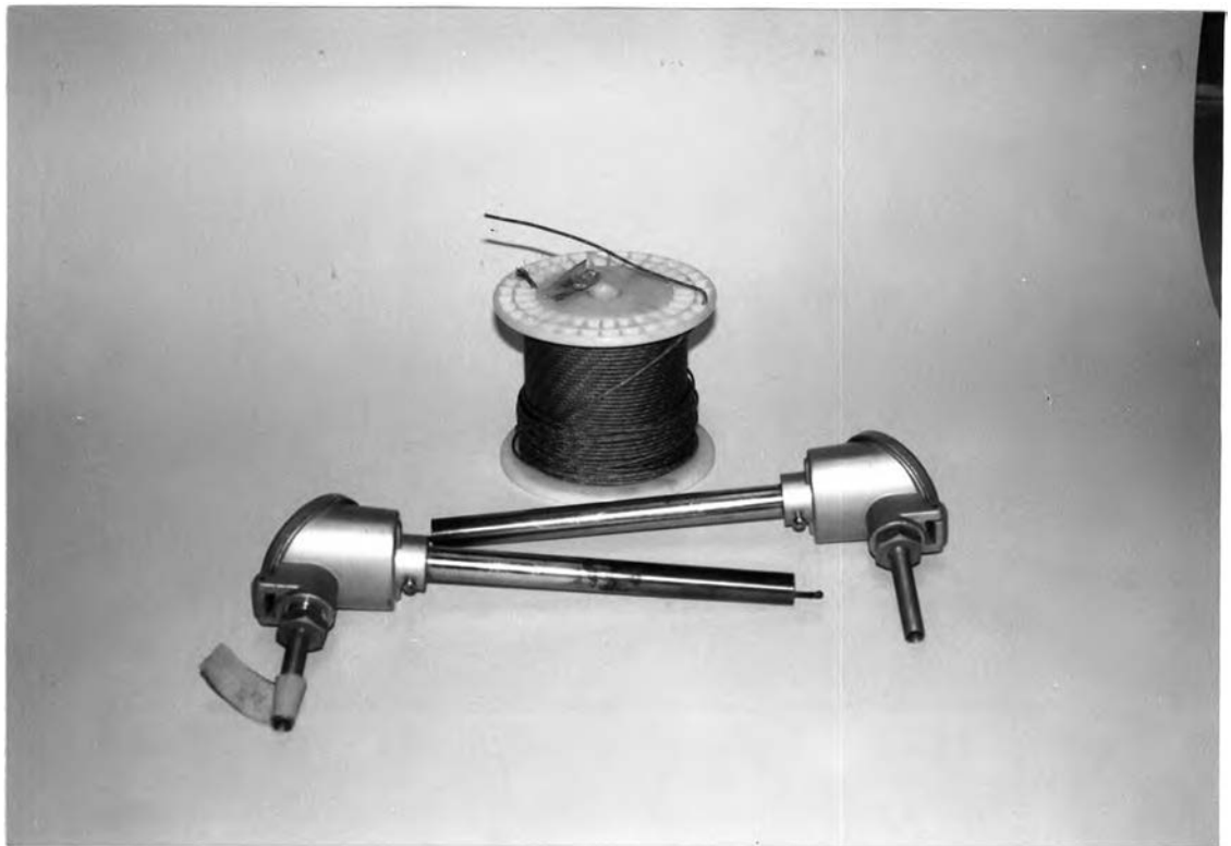
รูปที่ 5.10 แสดงเทอร์โมคัปเปิลชนิด K แบบสาย และ แบบ probe
