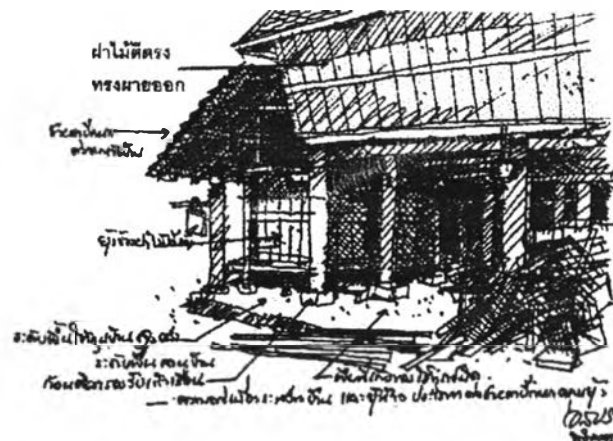
รูปที่ 5.10.1 ลักษณะของฝาเรือนผายออก แบบห้องควาย ของ บ้านไตลื้อ ในสิบสองพันนา (อรศิริ ปาณินท์, 2538: 87)
