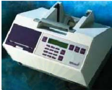
รูปที่ 4 แสดงเครื่องวัดความหนาแน่นมวลกระดูกสันเท้ารุ่น Hologic Sahara
