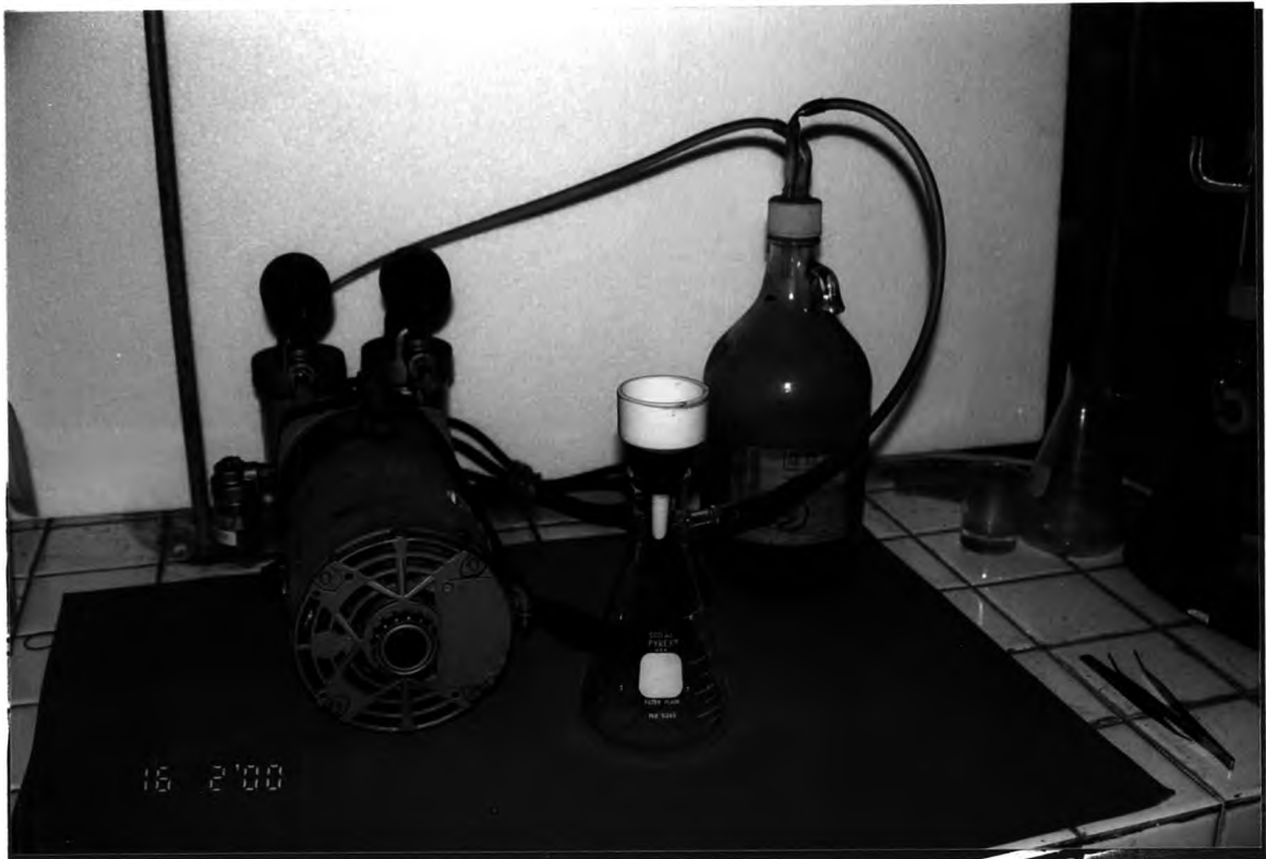
รูปที่ ๘.๖ เครื่องกรอง ที่ใช้ในการกรองสารละลายที่ผ่านการสกัดสารตามประกาศ กระทรวงอุตสาหกรรม ฉบับที่ 6 (พ.ศ. 2540)
