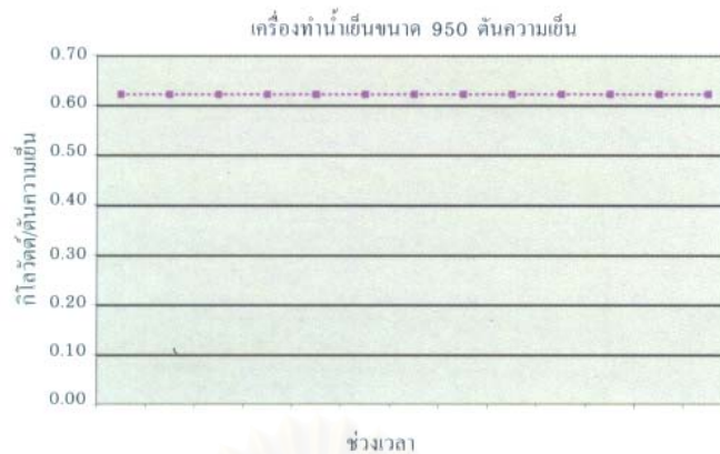
รูปที่ ข.7 แผนภาพแสดงสมรรถภาพการทำความเย็นของเครื่องทำน้ำเย็นขนาด 950 ตัน
