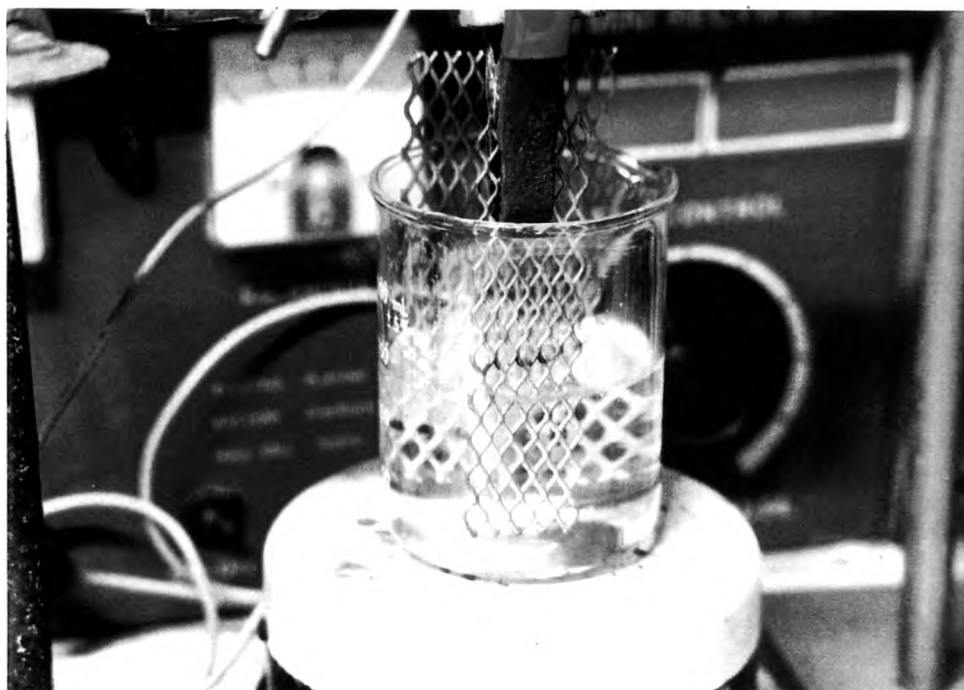
รูปที่ 3 ขณะทำการทดลองแยกสลายด้วยไฟฟ้าโดยใช้เครื่องกวนแม่เหล็กกวนสารละลาย
