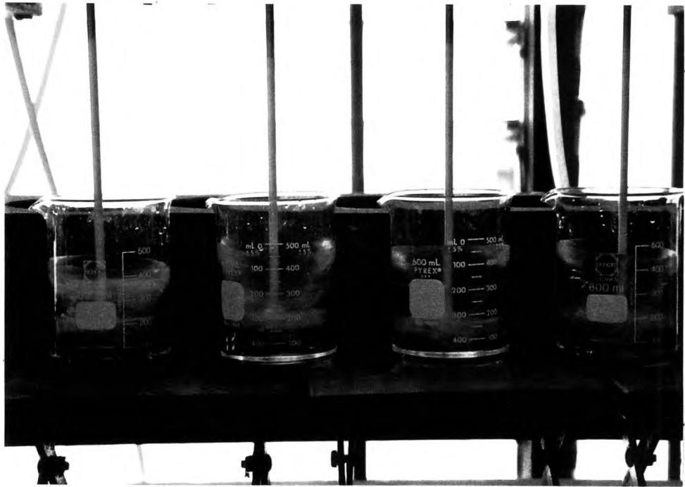
รูปที่ 5 ขณะทำการทดลองตกตะกอนปรอทโดยใช้เครื่องกวนใบพัดกวนสารละลาย
