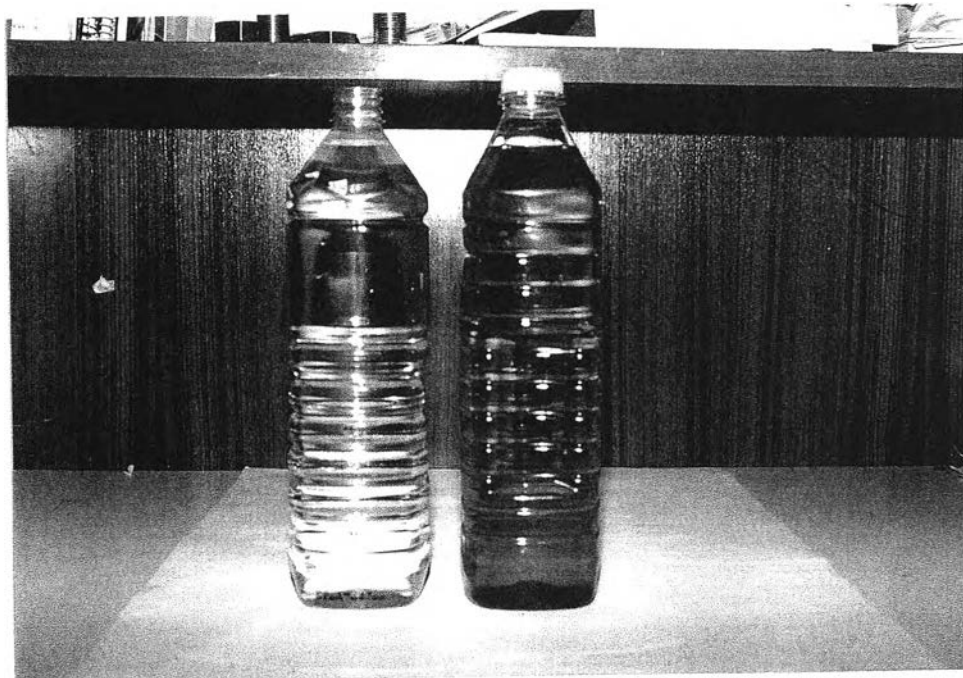
รูปที่ 7.43 แสดงตัวอย่างของน้ำเสีย ที่ออกจากระบบเครื่องเก็บอนุภาค ในการทดลองที่ 1 (160 %EA, อัตราส่วนของน้ำต่อแก๊ส 0.4 \text{ L.H}_2\text{O/m}^3 \cdot \text{gas} , หัวฉีดน้ำ 1.5 mm)
