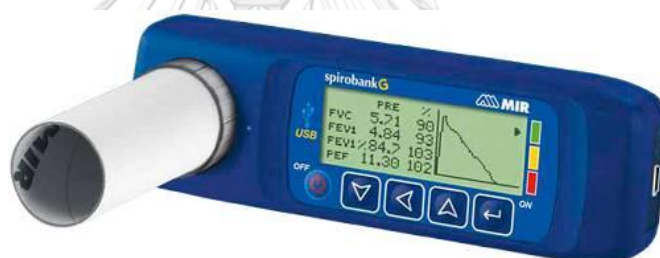
รูปที่ 11 เครื่องวัดปริมาตรการหายใจ (Spirometer)
