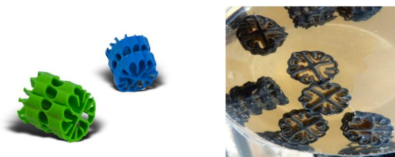
รูปที่ 3.2 ตัวกลางพลาสติกของบริษัท AQWISE ที่ใช้ในงานวิจัย
