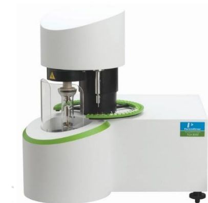
รูป 3.6 เครื่องวิเคราะห์เชิงอุณหภูมิกความร้อน ยี่ห้อ Perkin Elmer รุ่น TGA 8000 [41]
