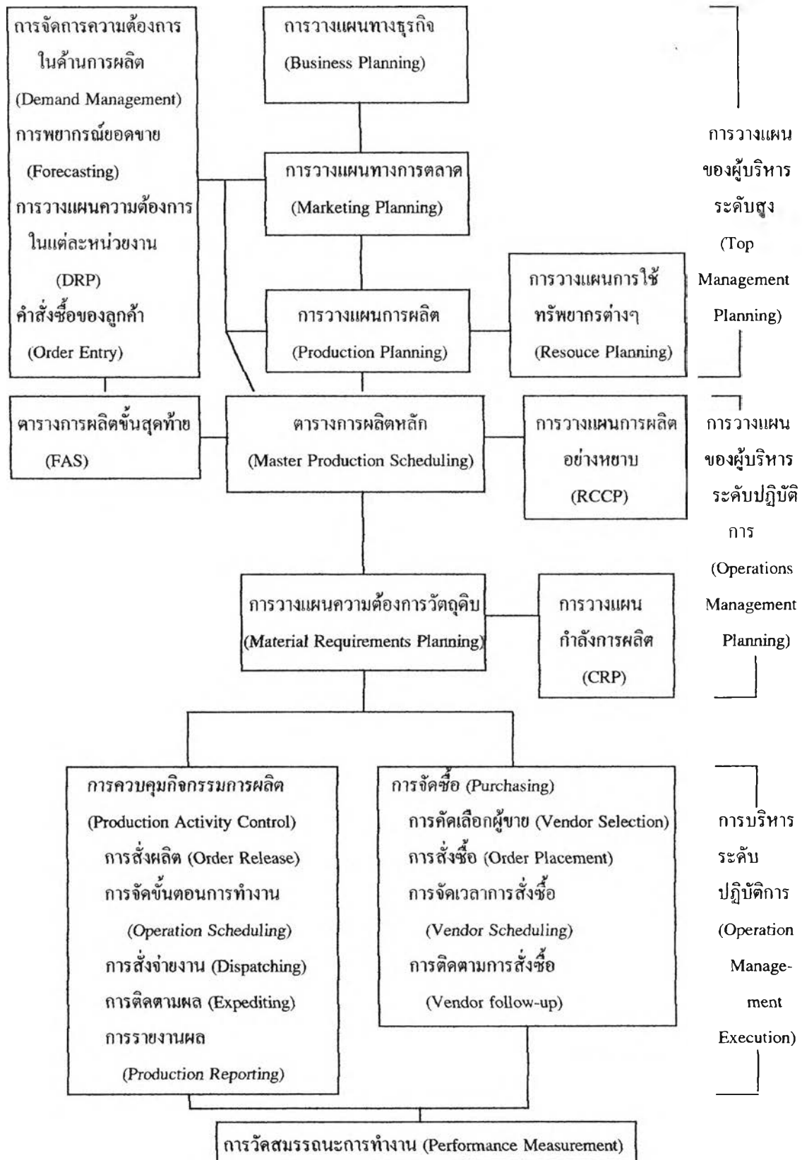
รูปที่ 2.1 แผนภูมิความสัมพันธ์ของการวางแผนการใช้ทรัพยากรการผลิต
