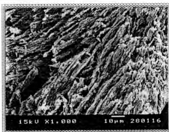
รูปที่ 4.22 SEM ดูหลังจากทำการทดลอง 8 วัน ในเครื่องฟลูอิดไคซ์เบด ตัวกลางที่เป็นอิฐ
