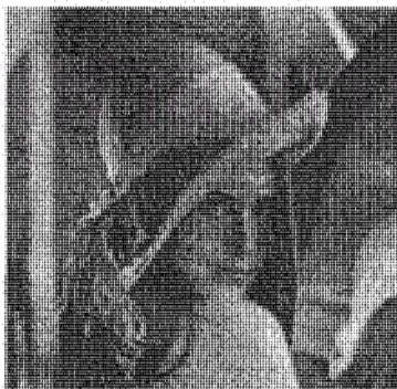
(ค) การลดทอนสัญญาณรบกวนวิธี VisuShrink แบบ Hard threshold
