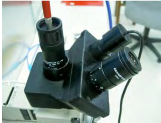
รูปที่ 8 : แสดงระบบการลำเลียงแสงเลเซอร์ผ่านกล้องจุลทรรศน์กำลังขยายสูง
