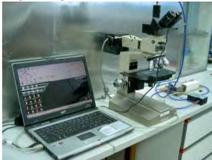
รูปที่ 7 : แสดงระบบการวัดความดันโดยเทคนิคการเรืองแสงของทับทิมที่พัฒนาขึ้นเพื่อใช้ในการวิจัย
