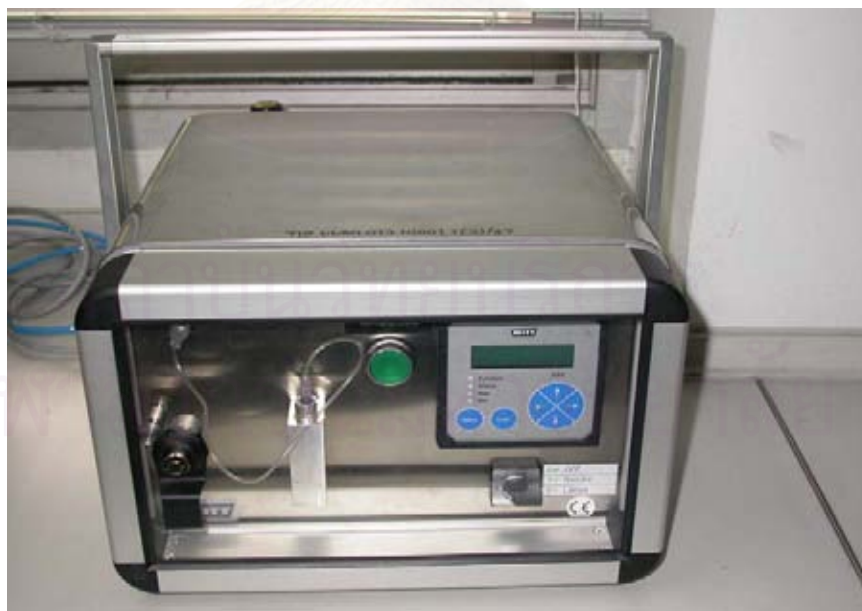
รูปที่ ข.2 เครื่อง headspace gas analyzer (Chamber Machines Vicchi Engineering Co., Ltd.)
