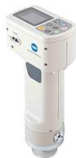
รูปภาพที่ 8 แสดงเครื่องมือ Chromameter (Minolta™)
