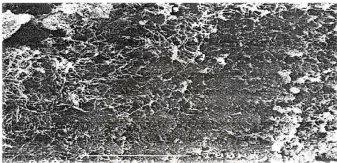
รูปที่ 5.21 ลักษณะของแบคทีเรียที่เกาะบนพื้นผิวเม็ดพลาสติก กำลังขยาย 370 เท่า
