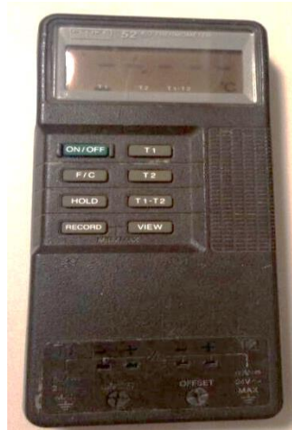
รูปที่ 3.3 เครื่องวัดอุณหภูมิ (Thermometer)
