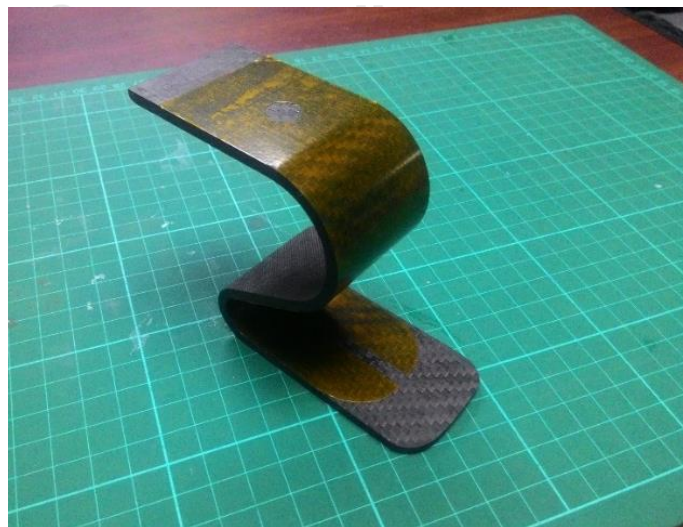
รูปที่ 4.18 ชิ้นส่วน heel ที่เจียรจนได้รูปร่างตามที่ต้องการ
