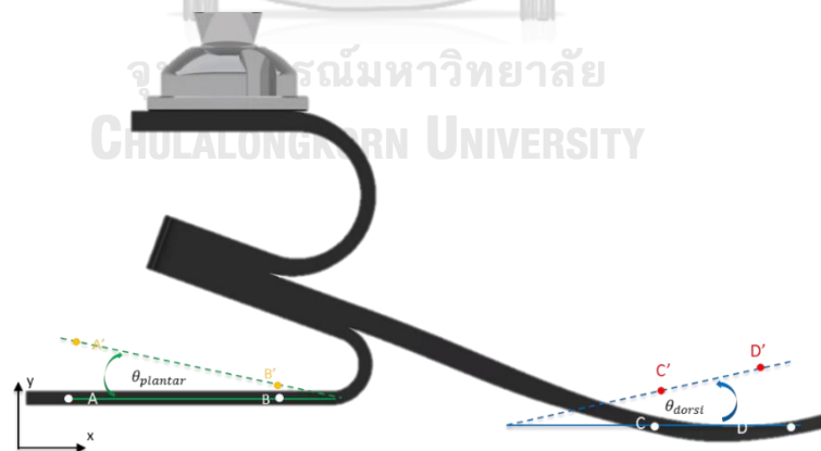
รูปที่ 1.8 การคำนวณมุม plantarflexion และ dorsiflexion ของ heel และ forefoot ของต้นแบบปรับปรุง
