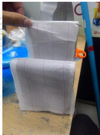
รูปที่ 4.10 การติด release film ลงบนผ้าคาร์บอนไฟเบอร์
