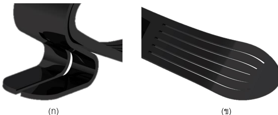
รูปที่ 3.9 การออกแบบสันเท้าและปลายเท้าแบบ (ก) ผ่าครึ่งซีก(split design) และ (ข) เซาะร่อง(slit design)
