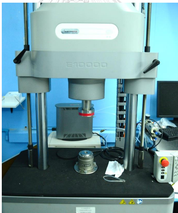
รูปที่ 5.1 เครื่องทดสอบคุณสมบัติของวัสดุเอนกประสงค์ (Instron: Electropulse E10000)
