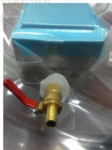
รูปที่ 4.12 การติดตั้งบอลวาล์วและถุงสุญญากาศ
