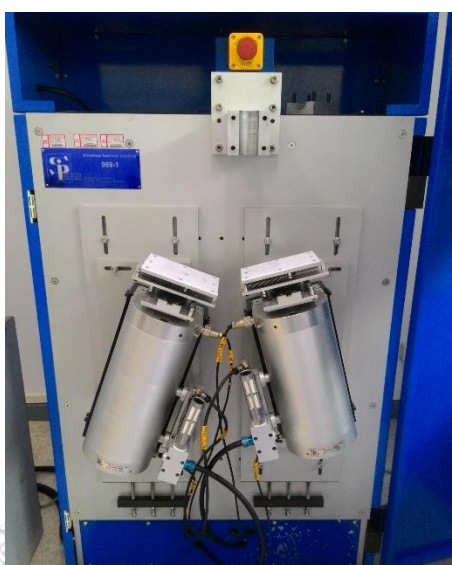
รูปที่ 6.1 เครื่องทดสอบความแข็งแรงของเท้าเทียม(Artificial testing machine)
