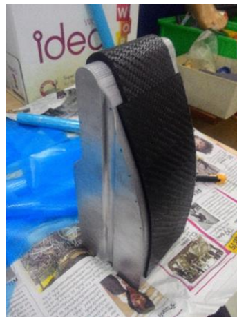
รูปที่ 4.9 การเรียงผ้าคาร์บอนไฟเบอร์ลงบนแม่พิมพ์
