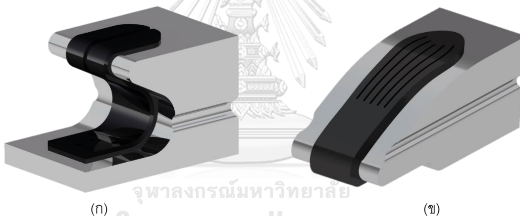
รูปที่ 4.1 แม่พิมพ์สำหรับขึ้นรูปวัสดุผสมคาร์บอนไฟเบอร์
