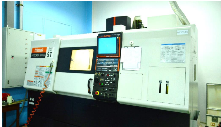
รูปที่ 4.4 เครื่อง CNC machining center รุ่น Integrex 100-IV ST ของบริษัท Mazak
