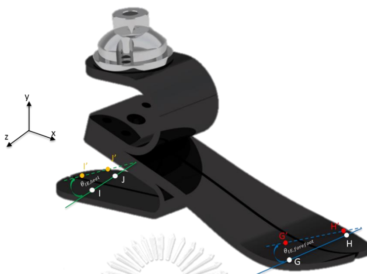
รูปที่ ข.9 การคำนวณมุม eversion หรือ inversion ของ heel และ forefoot ต้นแบบปรับปรุง
