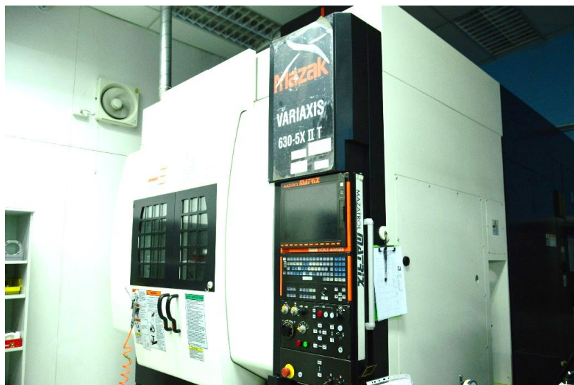
รูปที่ 4.2 เครื่อง CNC machining center รุ่น VARIAXIS 630-5x II T ของบริษัท MAZAK
