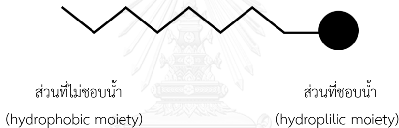
รูปที่ 2.1 แสดงลักษณะโครงสร้างโดยทั่วไปของของสารลดแรงตึงผิวชีวภาพ (Cooper, 1986)
