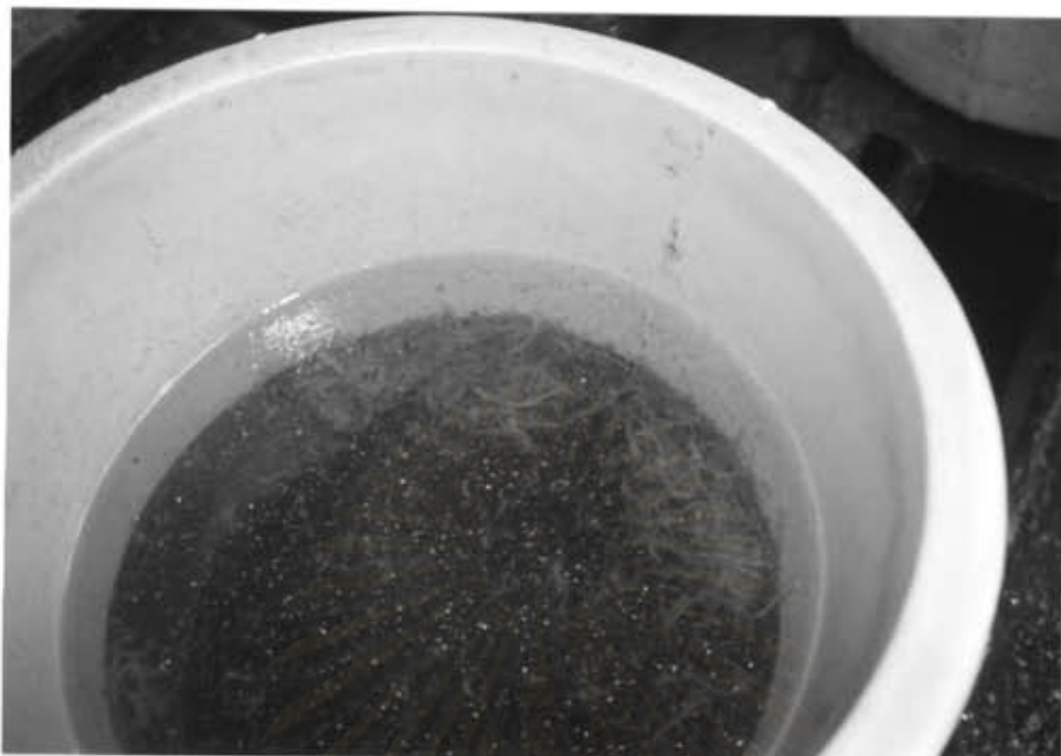
รูปที่ 4.7 การเกิดจุลินทรีย์ชนิดเส้นใยในถัง AMBF ของชุดการทดลองที่ 4
