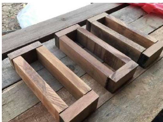
รูปที่ 3.9 แม่พิมพ์สำหรับขึ้นเปเปอร์ครีต
