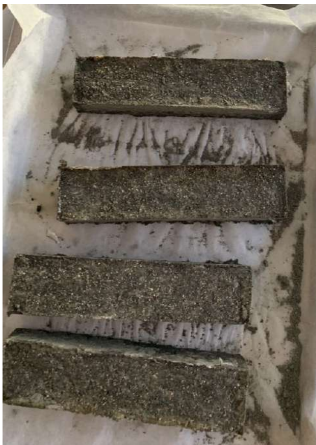
รูปที่ 5 เมื่อเปเปอร์คริตแห้งตัวแล้วนำออกจากพิมพ์
