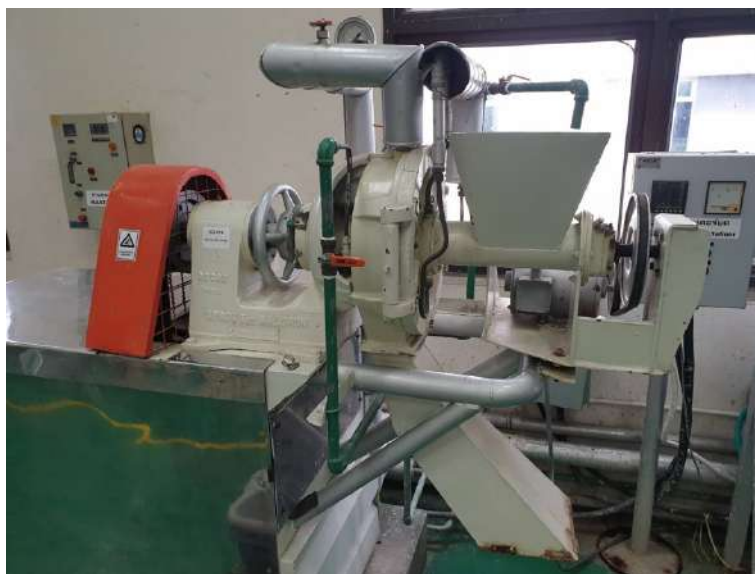
รูปที่ 3.3 เครื่องบด Atmospheric refiner
