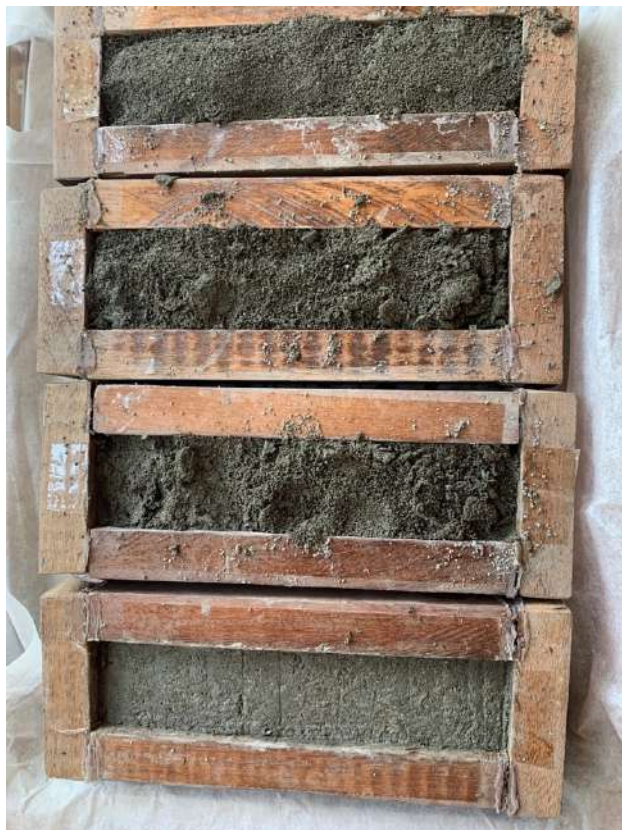
รูปที่ 4 อัดขึ้นรูปเปเปอร์คริตด้วยแม่พิมพ์
