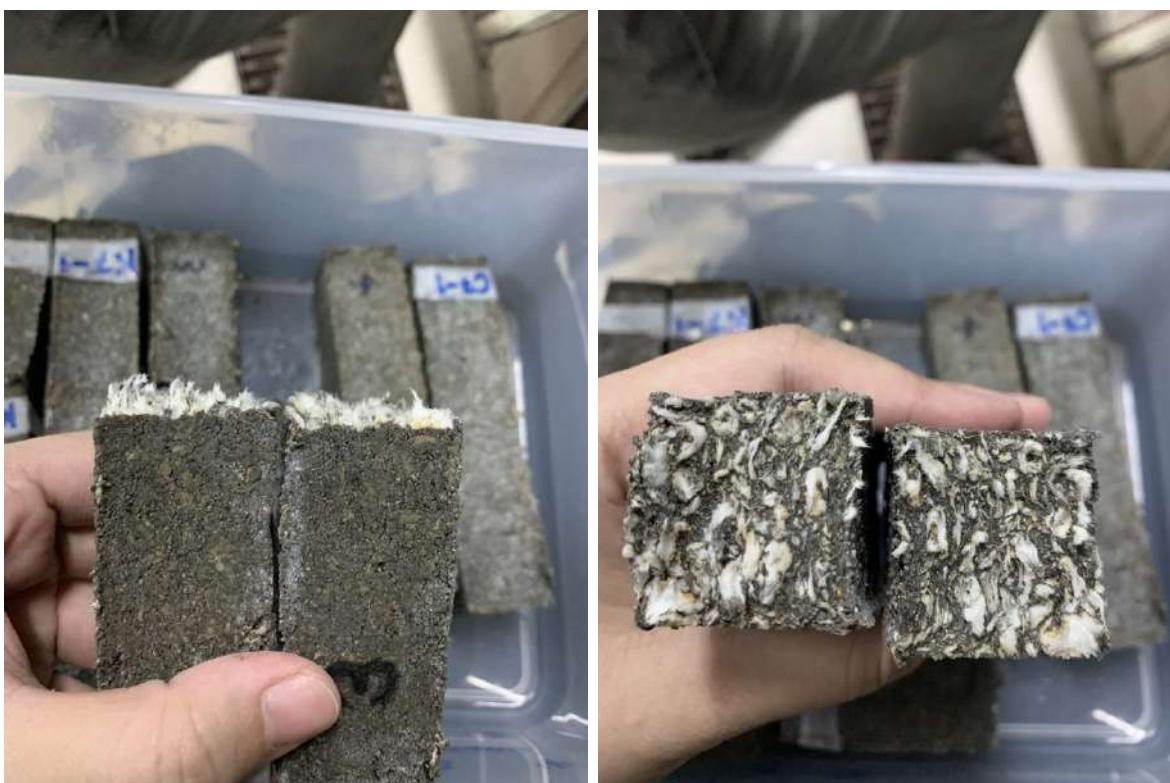
รูปที่ 7 เปเปอร์คริตที่ผลิตจากเยื่อกระดาษทางการค้าหลังทดสอบความแข็งแรง (MOR)
