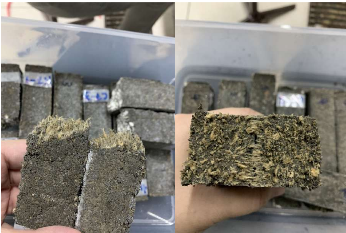
รูปที่ 6 เปเปอร์คริตที่ผลิตจากเยื่อหนุ่นหลังทดสอบความแข็งแรง (MOR)
