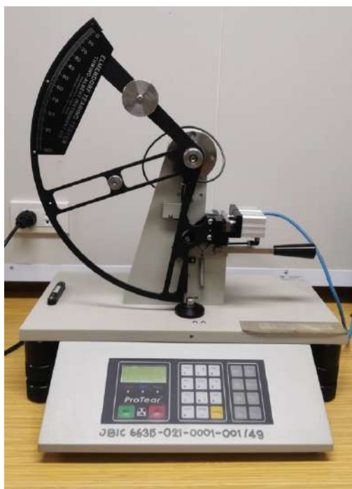
รูปที่ 3.7 เครื่องวัดความต้านทานแรงฉีก (Tear tester)
