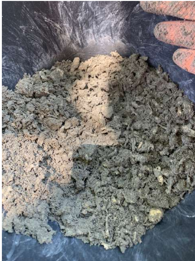
รูปที่ 3 เตรียมเปเปอร์คริตโดยผสมทราย ปูนซีเมนต์พอร์ตแลนด์ น้ำ และเยื่อ ให้เข้ากัน
