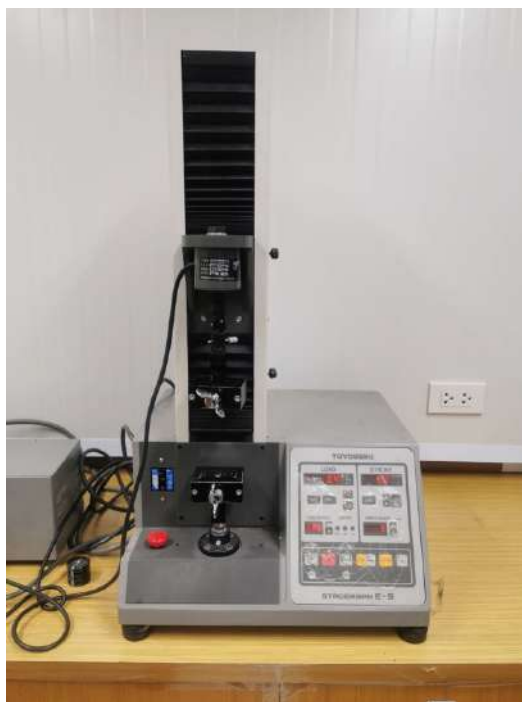
รูปที่ 3.6 เครื่องวัดความแข็งแรงต่อแรงดึง (Tensile tester)
