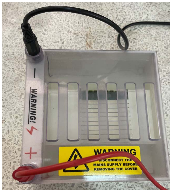
ภาพที่ 4 ตรวจสอบ PCR product ด้วยวิธี agarose gel electrophoresis
