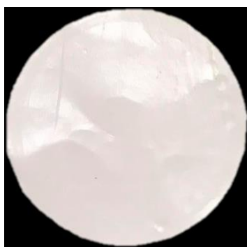
รูปที่ 11 ลักษณะแผ่นเมมเบรนพอลิซัลโฟน
