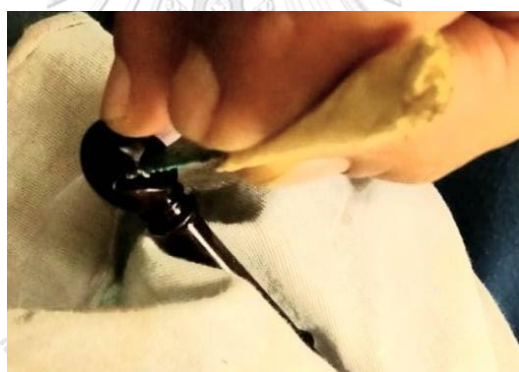
ภาพที่ 3.109 การบากปากที่หัวปลายคันทันชักสำหรับให้หางม้าแผ่ขยาย
