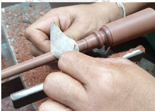
ภาพที่ 3.92 การขัดเก็บรายละเอียดชิ้นงานด้วยกระดาษทรายสับในเครื่องกลึง
