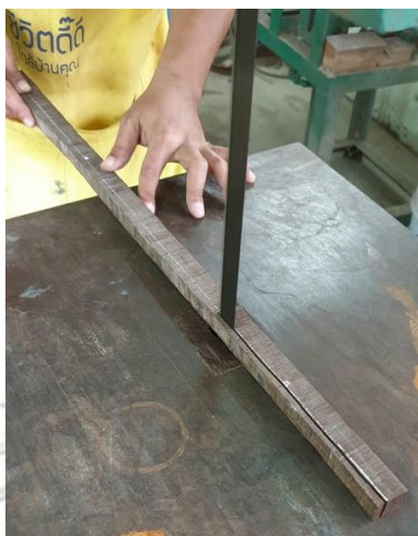
ภาพที่ 3.93 การเลื่อยไม้สำหรับทำคันทันชัก
