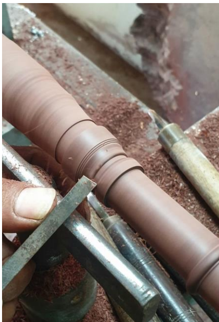
ภาพที่ 3.79 การกลึงบัวเหยียบกะโหลก
