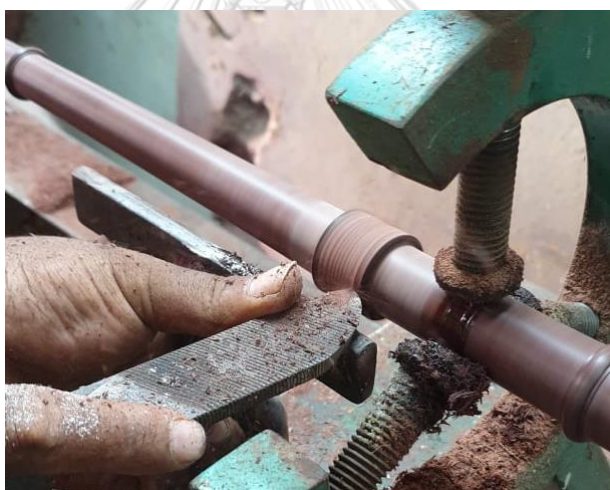
ภาพที่ 3.82 การกลึงไล่ไม้บริเวณสามทางจับ ที่มาภาพ : ชลพรรษ เต็จใจ บันทึกภาพเมื่อวันที่ 2 ตุลาคม 2564
