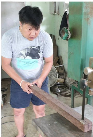
ภาพที่ 3.73 การเลื่อยไม้สำหรับทำคันทวนขอ ที่มาภาพ : ชลพรรษ เต็จใจ บันทึกภาพเมื่อวันที่ 2 ตุลาคม 2564
