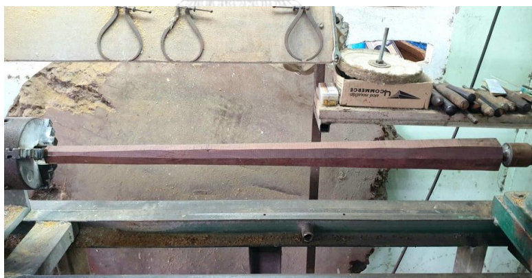
ภาพที่ 3.76 ไม้ที่ลบเหลี่ยมแล้วเข้าเครื่องกลึง หัวจับที่ก้านคันทวนและยันศูนย์ที่หัวคันทวน
