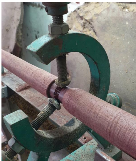
ภาพที่ 3.77 สามทางจับชิ้นงานและกลึงปอกให้กลม ที่มาภาพ : ชลพรพรช เด็จใจ บันทึกภาพเมื่อวันที่ 2 ตุลาคม 2564
