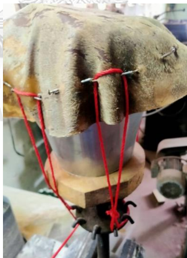
ภาพที่ 3.68 การขึ้นหนังหน้าซอและเร่งความตึงเชือกเพื่อให้หนังตึง
