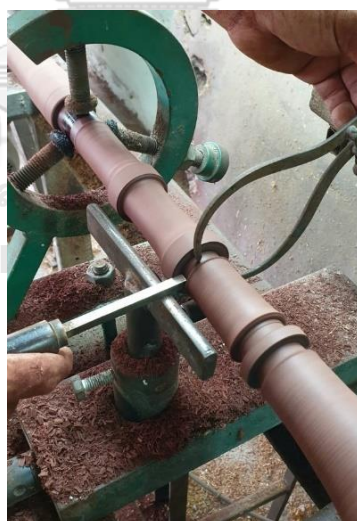
ภาพที่ 3.78 กำหนดตำแหน่งและกลึงลูกแก้ว ที่มาภาพ : ชลพรพรช เด็จใจ บันทึกภาพเมื่อวันที่ 2 ตุลาคม 2564
