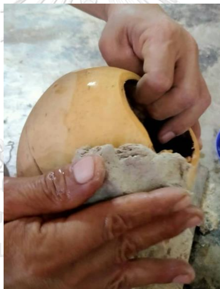
ภาพที่ 3.58 กาวอีพ็อกซีผสมกับซีเมนต์พอกบริเวณขอบกะโหลก
