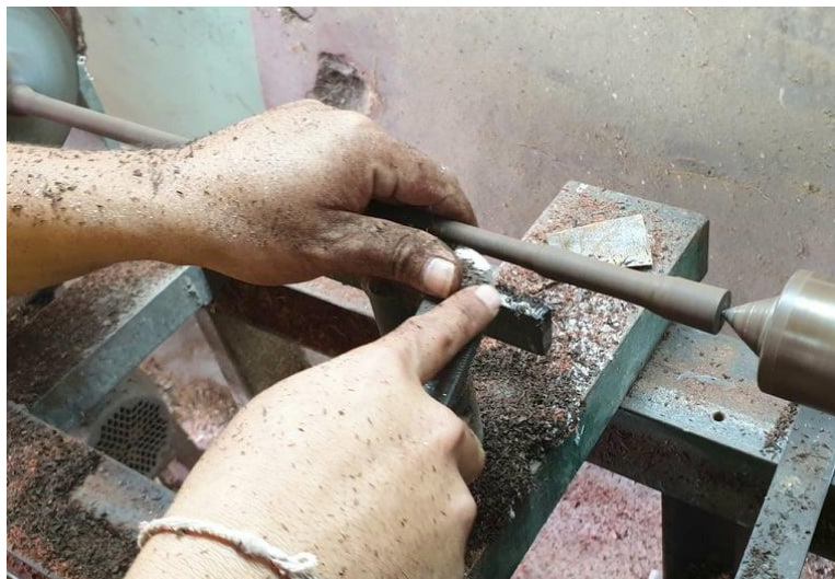
ภาพที่ 3.99 การประคองคันชักด้วยมือซ้ายและทำการกลึงด้วยมือขวา ที่มาภาพ : ชลพรรษ เต็จใจ บันทึกภาพเมื่อวันที่ 2 ตุลาคม 2564
