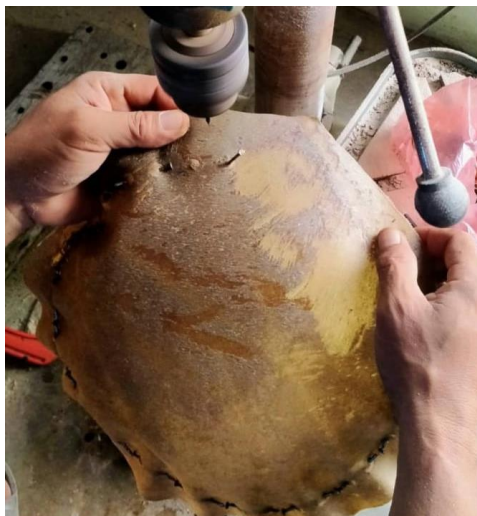
ภาพที่ 3.67 การเจาะรูตามขอบหนังเพื่อกลัดตะปู
