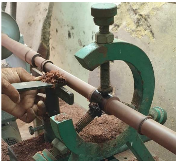
ภาพที่ 3.81 การกลึงไล่คันทวนให้มีลักษณะเรียวยางด้านล่าง ที่มาภาพ : ชลพรรษ เต็จใจ บันทึกภาพเมื่อวันที่ 2 ตุลาคม 2564
