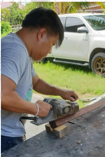
ภาพที่ 3.74 การลบเหลี่ยมคันทวนด้วยกบไฟฟ้า ที่มาภาพ : ชลพรรษ เต็จใจ บันทึกภาพเมื่อวันที่ 2 ตุลาคม 2564
