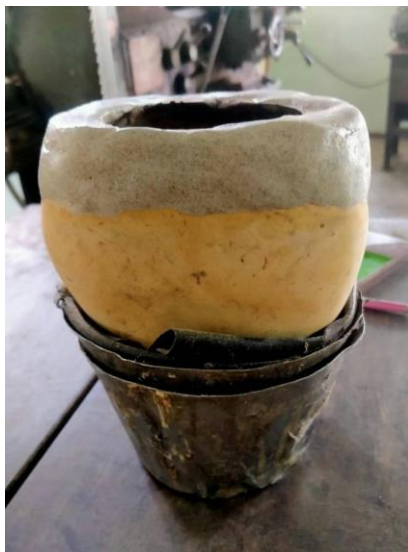
ภาพที่ 3.59 กาวอีพ็อกซีผสมกับซีลี้อยพอกบริเวณขอบกะโหลกเสร็จเรียบร้อยแล้ว
