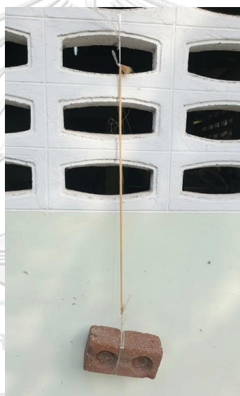
ภาพที่ 3.111 หางม้าที่ถ่วงด้วยอิฐ ที่มาภาพ : ชลพรพรช เต็จใจ บันทึกภาพเมื่อวันที่ 2 ตุลาคม 2564
