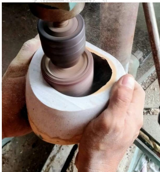
ภาพที่ 3.62 การขัดหน้ากะโหลกซอด้านในด้วยหัวกระดาษทรายจับกับแท่นเจาะสว่าน ที่มาภาพ : ชลพรรษ เต็จใจ บันทึกภาพเมื่อวันที่ 28 กุมภาพันธ์ 2564
