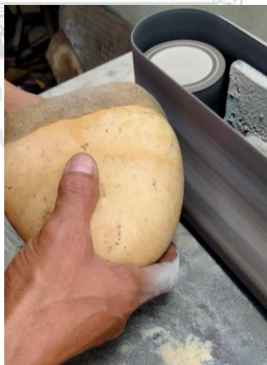
ภาพที่ 3.60 การขัดหน้ากะโหลกซอด้านนอกด้วยเครื่องขัดกระดาษทรายสายพาน
