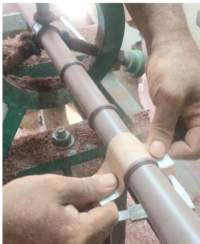
ภาพที่ 3.83 การขัดเก็บรายละเอียดชิ้นงานด้วยกระดาษทรายในเครื่องกลึง ที่มาภาพ : ชลพรพรช เต๋จใจ บันทึกภาพเมื่อวันที่ 2 ตุลาคม 2564
