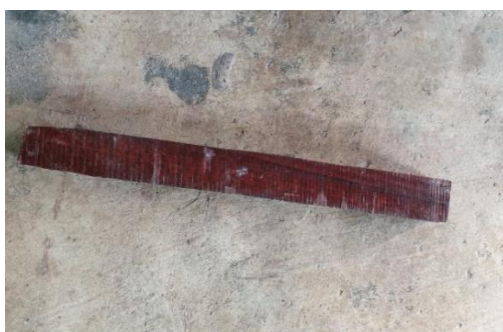
ภาพที่ 3.71 การเตรียมไม้ Snakewood ที่ไม่ติดลายสำหรับกลึงคันทวน
