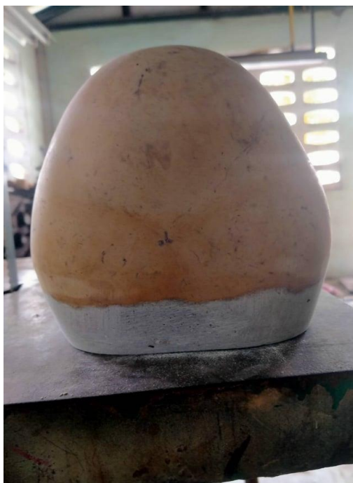
ภาพที่ 3.61 การขัดหน้ากะโหลกซอด้านนอกที่เสร็จเรียบร้อยแล้ว ที่มาภาพ : ชลพรรษ เต็จใจ บันทึกภาพเมื่อวันที่ 28 กุมภาพันธ์ 2564
