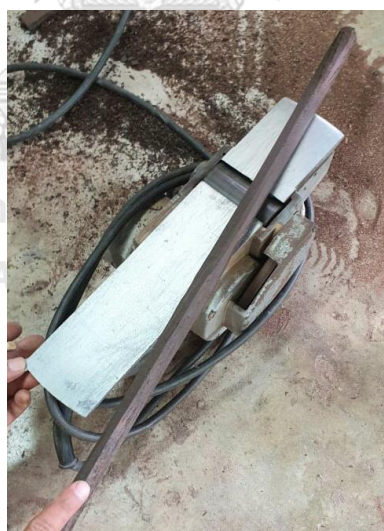
ภาพที่ 3.94 การลบเหลี่ยมไม้สำหรับทำคันทันชัก
