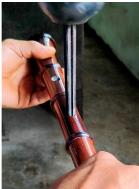
ภาพที่ 3.104 การใช้ดอกกริมเมอร์คว้านรูสำหรับใส่ลูกบิด ที่มาภาพ : ชลพรรษ เต็จใจ บันทึกภาพเมื่อวันที่ 2 ตุลาคม 2564
