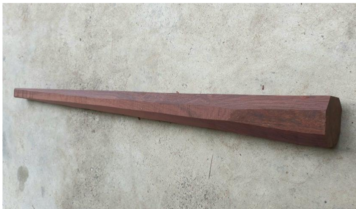
ภาพที่ 3.75 คันทวนที่ลบเหลี่ยมเสร็จแล้ว
