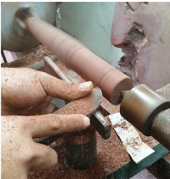
ภาพที่ 3.87 กลึงปอกชิ้นรูปให้ชิ้นงานมีลักษณะกลม ที่มาภาพ : ชลพรรษ เต็จใจ บันทึกภาพเมื่อวันที่ 2 ตุลาคม 2564
