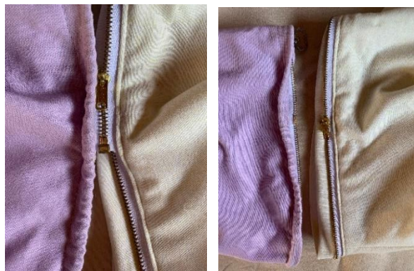
ภาพที่ 4.22 การทดลองเย็บซิปถอดได้ แบบหัวเดียว สำหรับถอดแยกหรือประกอบชิ้นส่วน ปัญหาที่พบ คือ ซิปที่บริเวณแขนขวาและซ้าย เมื่อรูดซิปจะรูดต่างกัน เนื่องจากซิปถอดได้นั้นเป็นซิปหัวเดียว รูดได้ทางเดียว
