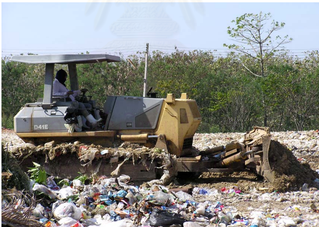
รูปที่ ง.12 แสดงการทำงานฝังกลบของรถ Tractor ของทม.เพชรบูรณ์
