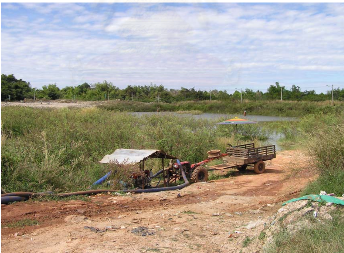
รูปที่ ง.54 การระบายน้ำด้วยเครื่องสูบน้ำเคลื่อนที่ของทม.สกลนคร
