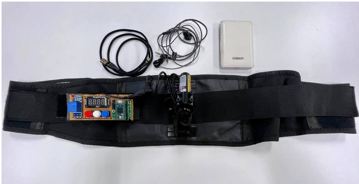
รูปที่ 23 เข็มขัดชี้นำทางการมองเห็น และการได้ยิน (Visual and auditory cue belts)
