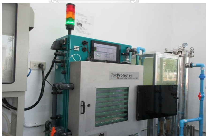
ภาพที่ 12 เครื่องมือในการตรวจจับพฤติกรรมของปลาเสือสุมาตรา
