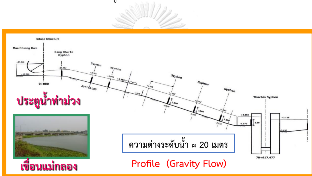
ภาพที่ 23 ภาพแสดงการไหลของน้ำผ่านแรงโน้มถ่วงของโลก (Gravity Flow) จากบริเวณประตูน้ำท่าม่วงถึงสถานีสูบน้ำดิบบางเลน
