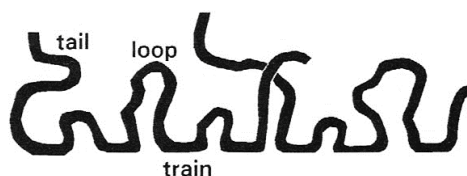
ภาพที่ 2-3 ภาพวาดการเชื่อมต่อระหว่างอนุภาคด้วย Loop, Train และ Tail ของสายโซ่พอลิเมอร์ด้วยกลไกการกักเก็บแบบ Bridge model [13]
