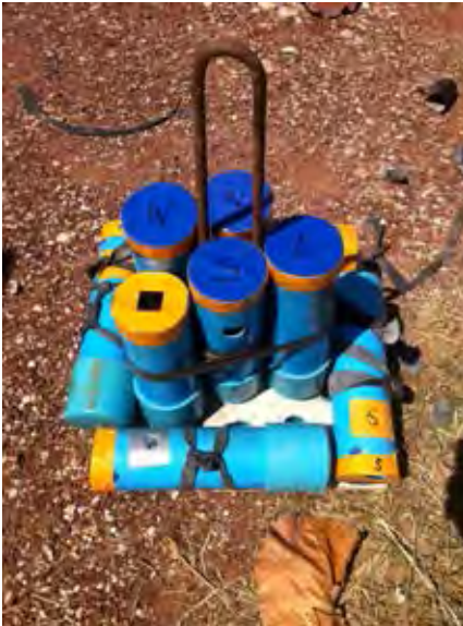
เครื่องดักตะกอนทำจากท่อพีวีซีบนโครงเหล็กและฐานปูน
