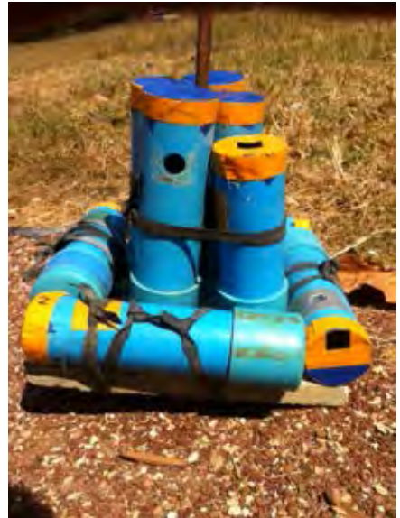
เครื่องดักตะกอนทำจากท่อพีวีซีบนโครงเหล็กและฐานปูน
