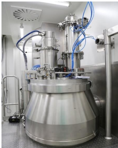
รูปที่ 5 เครื่อง High shear granulator ที่มีความสำคัญอย่างมากในการทำแกรนูลเปียก
