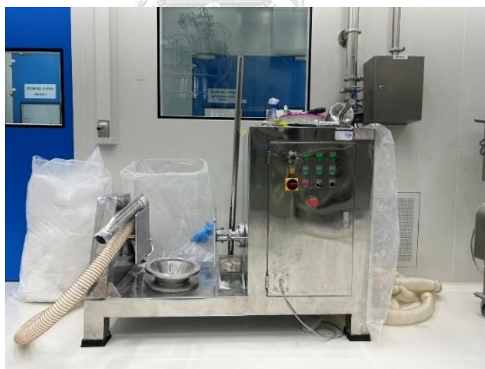
รูปที่ 3 เครื่องบีบอัดใช้สำหรับบีบอัดวัตถุดิบยาเมตฟอร์มิน
