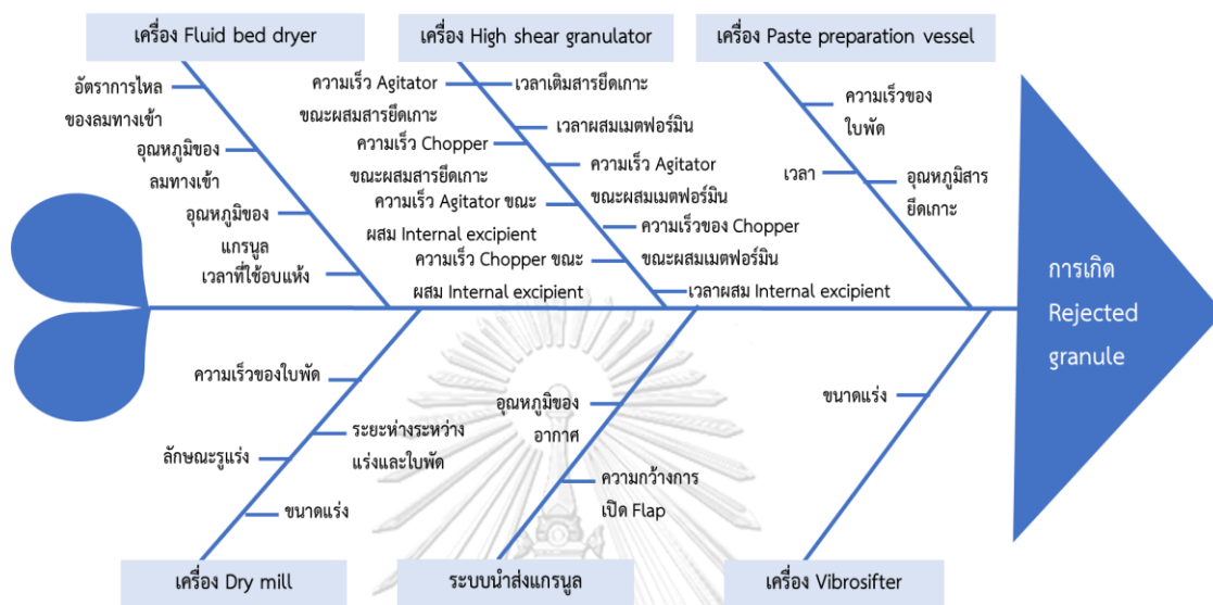
รูปที่ 26 ปัจจัยที่ส่งผลต่อการเกิด Rejected granule โดยใช้เครื่องมือ Fishbone diagram
