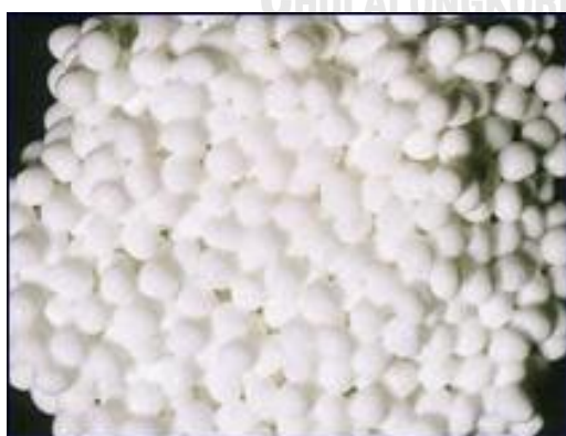
รูปที่ 2.9 โครงสร้างภายในตัวกลางพีวีเอเจล
