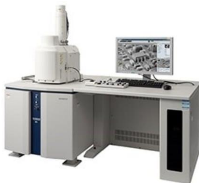
รูปที่ 3.9 กล้องจุลทรรศน์อิเล็กตรอนแบบส่องกราด ยี่ห้อ Hitachi รุ่น SU3500-Horiba X-maxN [130]
