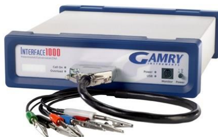
รูปที่ 3.12 เครื่องทดสอบคุณสมบัติทางไฟฟ้าเคมีของแบตเตอรี่ ก) ยี่ห้อ Autolab รุ่น PSGSTAT30 [133] และ ข) ยี่ห้อ Gamry รุ่น Interface1010E [134]
