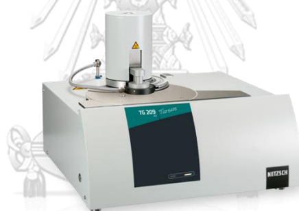
รูปที่ 3.3 เครื่องวิเคราะห์เชิงอุณหภูมิความร้อน ยี่ห้อ NETZSCH รุ่น TG 209 F3 Tarsus 8000
