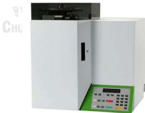
รูปที่ 3.4 เครื่องวิเคราะห์องค์ประกอบธาตุ ยี่ห้อ Perkin Elmer รุ่น EA 2400 Series II [125]
