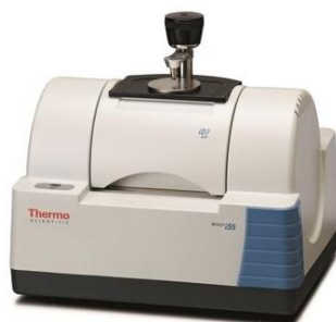
รูปที่ 3.6 เครื่องฟูเรียร์ทรานส์ฟอร์มอินฟราเรดสเปกโทรมิเตอร์ ยี่ห้อ Thermo Scientific รุ่น Nicolet iS5 [127]
