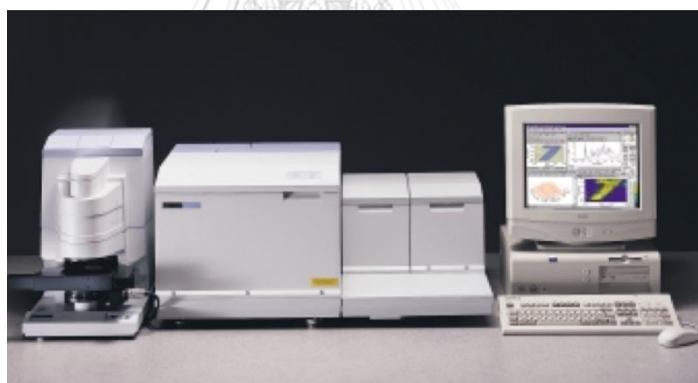
รูปที่ 3.5 เครื่องฟูเรียร์ทรานส์ฟอร์มรามานสเปกโตรมิเตอร์ ยี่ห้อ Perkin Elmer รุ่น Spectrum GX
