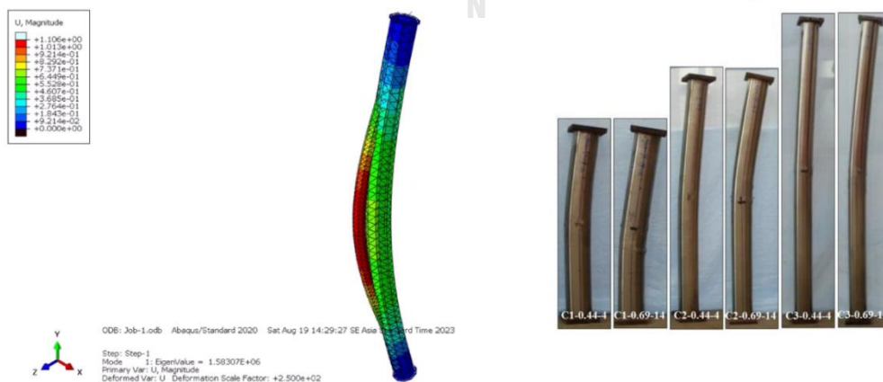
รูปที่ 11 แสดงลักษณะการวิบัติของเสา CF DST
