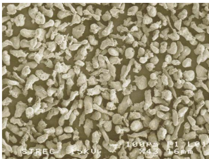
รูปที่ 4.3 ภาพจาก SEM แสดงลักษณะของพอลิเอทิลีนไดออลที่มีขนาดพอง 148.8 \mu\text{m} ที่กำลังขยาย 43 เท่า (ภาคผนวกรูปที่ ข.1)
