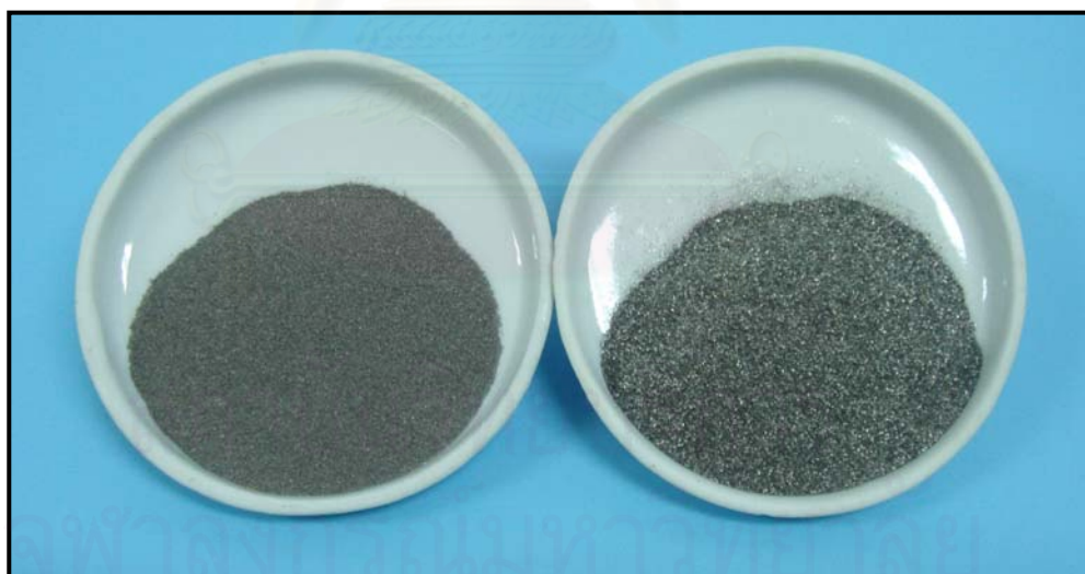
รูปที่ 4.5 ลักษณะของผงอะลูมิเนียมผสมแมงกานีสไดออกไซด์โดยด้วยทางซ้ายเป็นการผสมกันแบบสุ่มโดยใช้วิธีคนให้เข้ากัน และด้วยทางขวาเป็นการผสมโดยใช้เครื่อง rocking mill
