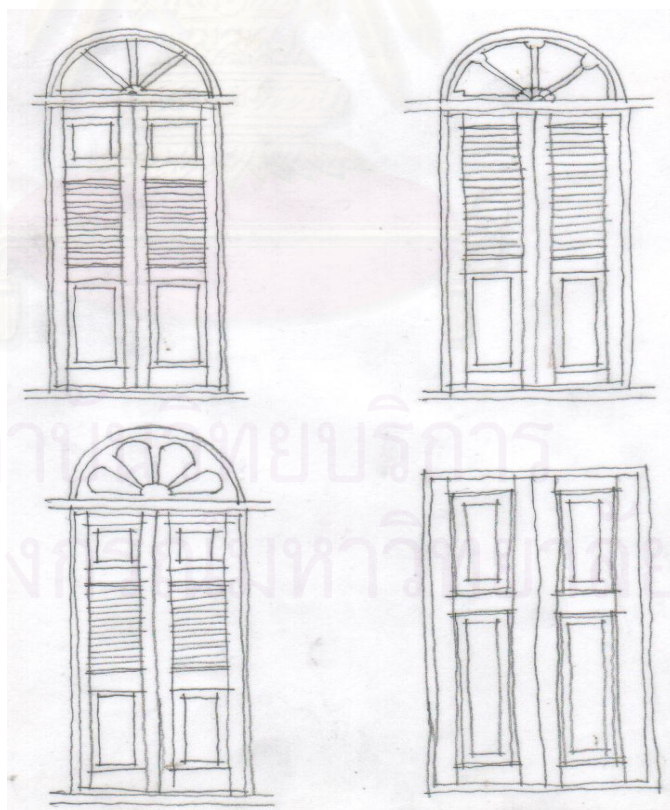
ภาพที่ 108 แสดงหน้าต่างที่มีการตกแต่งด้วยกรอบไม้ครึ่งวงกลมเหนือกรอบบาน
